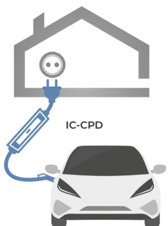
Bei Neuinstallationen, Änderungen und Erweiterungen elektrischer Anlagen ist das Vorhandensein einer Fehlerstrom-Schutz-einrichtung in der Infrastruktur zwingend erforderlich. Dies ist beim Bereitstellen von Ladepunkten für diese Ladebetriebsart zu berücksichtigen. Weiterhin ist die Stromtragfähigkeit der Steckdose sowie der dahinterliegenden Leitungsinstallation zu beachten, die oftmals nicht für eine dauerhafte Belastung ausgelegt ist.
